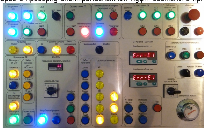
Пульт управления станком. (Индикаторы показывают Err – отключены SSI датчики.)
